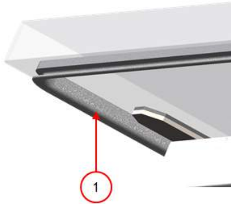
Abbildung 16: Austausch der Deckeldichtung
